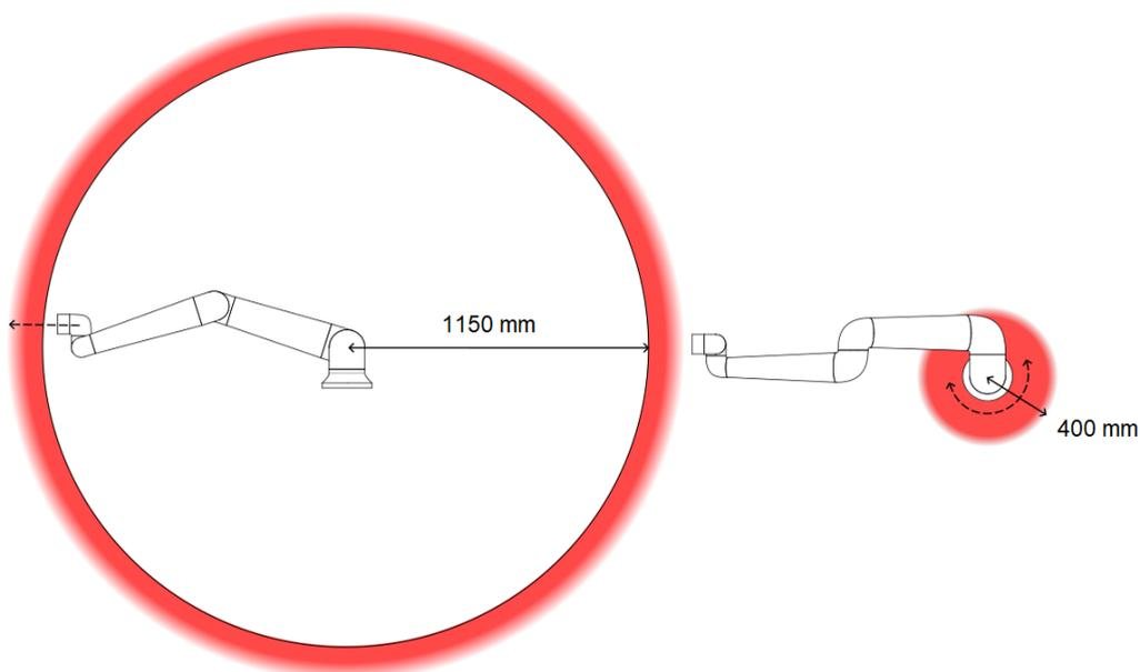
*À cause des propriétés physiques du bras du robot, certaines zones de l'espace de travail nécessitent une attention particulière quant aux risques de pincement. Une zone (à gauche) est définie pour les mouvements radiaux, lorsque l'articulation du poignet 1 est à au moins 1 150 mm de la base du robot. L'autre zone (à droite) est à 400 mm de la base du robot, lorsqu'il se déplace dans la direction longitudinale.*
