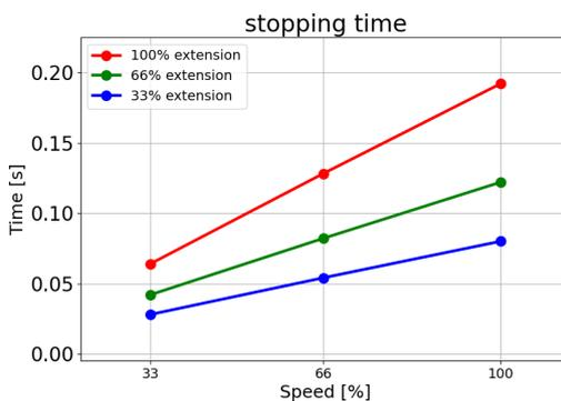
Temps d'arrêt en secondes pour 66 % de 17,5 kg
