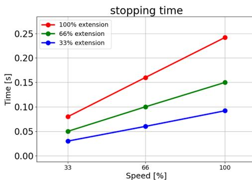
Temps d'arrêt en secondes pour une charge utile maximale de 17,5 kg
