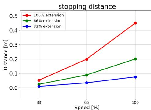
Distance d'arrêt en mètres pour une charge utile maximale de 17,5 kg
