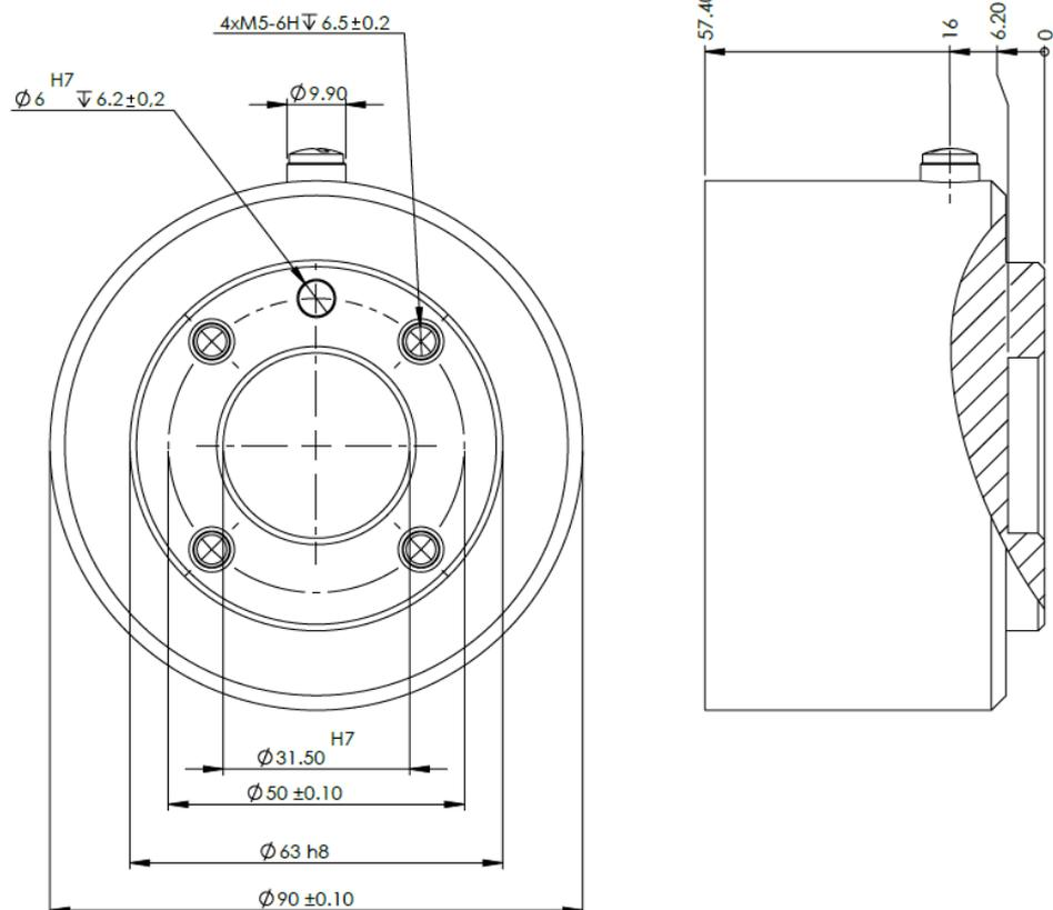
Dimensions et le modèle de trous de la bride de l'outil. Toutes les mesures sont en millimètres.
