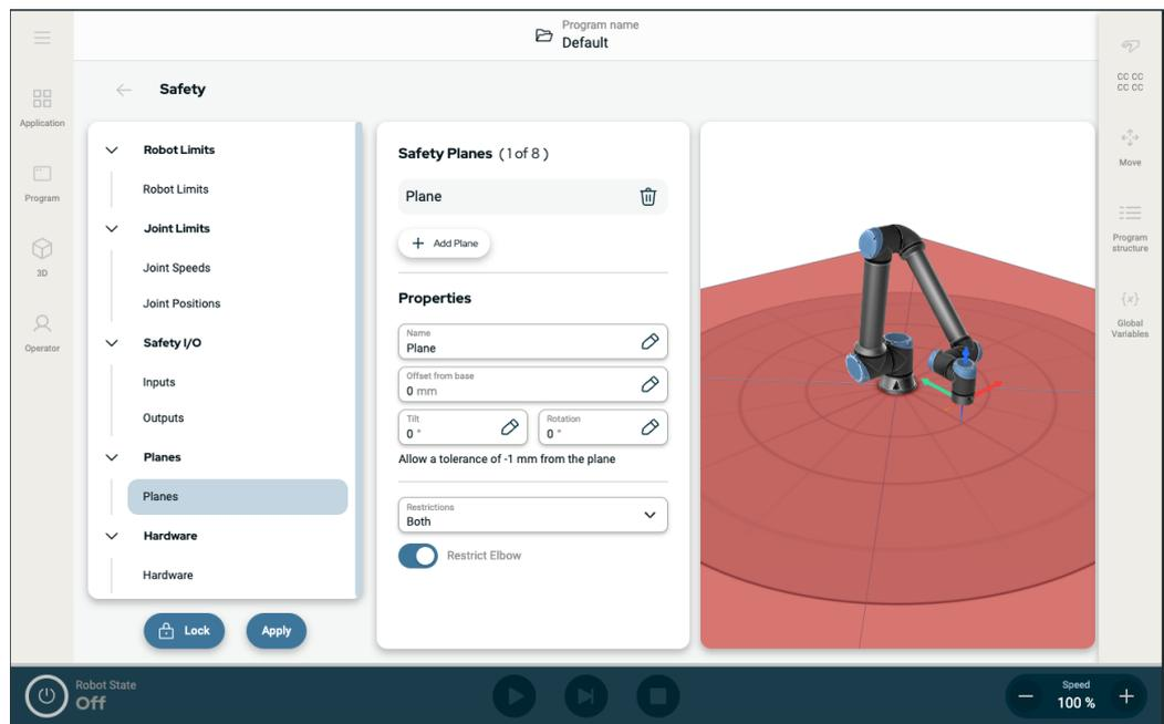
Figure 1.4: Écran PolyScope X affichant les plans de sécurité.
