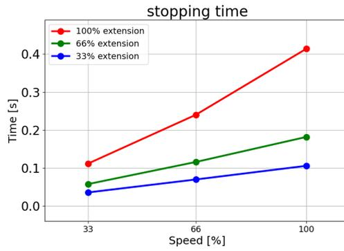
Temps d'arrêt en secondes pour une charge utile maximale de 17,5 kg
